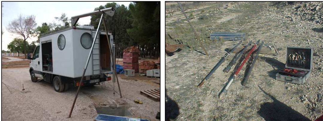
Figura 11. Unidad de Reconocimiento de sondeos y sondas geofísicas. Los fundamentos y características técnicas de los registros geofísicos se describen en los siguientes apartados.
