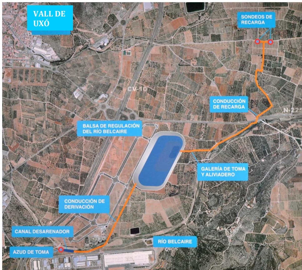
Figura 3. Esquema general de las instalaciones de recarga
